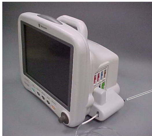
DASH CapnoFlex LF CO 2 Module
