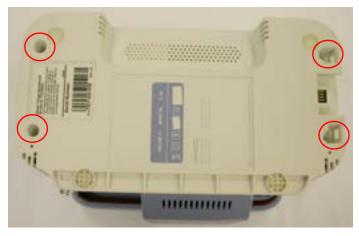
FIGURE 8-6: BOTTOM ENCLOSURE SCREW LOCATIONS
