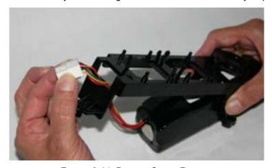
FIGURE 8-14: PROPER CABLE ROUTING
